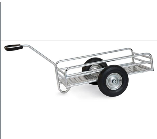
Handwagen für die Verwendung im Außenbereich. Aus Stahlrohr geschweißt, feuerverzinkt. Ladefläche aus Alu-Quintettblech. Geländer 180/250 mm hoch mit kräftigen Rohrverstreben. Anschraubbare Deichsel mit Sicherheitsgriff und hautsympathischem Softgrip-Bezug. Große Räder mit verzinkter Stahlblechfelge, mit Luftbereifung, Naben mit Rollenlager. Verschraubte Radbefestigung für einfachen Radwechsel.
