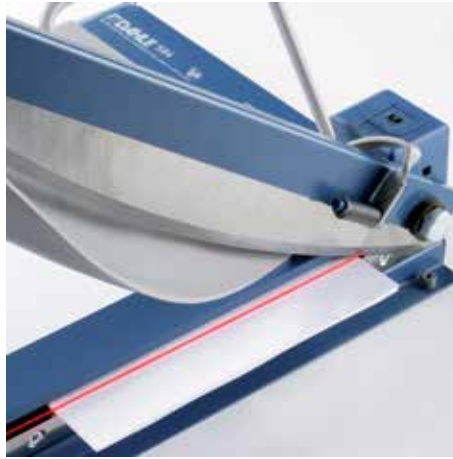
Präzise Laserlicht-Schnittandeutung sorgt für professionelle Schneideergebnisse
