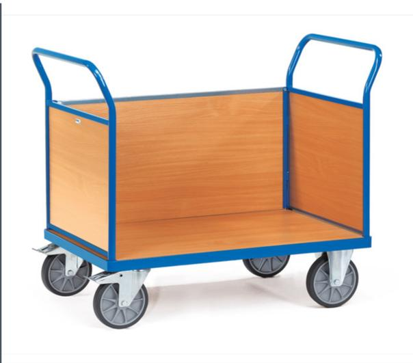
Stahlrohr und Profilstahl geschweißt, pulverbeschichtet RAL 5007, Plattform Holzwerkstoffplatte, Oberfläche Buchendekor. 2 Stirnwände und 1 Längswand aus Holzwerkstoffplatte, Oberfläche Buchendekor, Wände 500 mm hoch. 2 Lenk- und 2 Bockrollen, TPE-Bereifung, Naben mit Rillenkugellager. Feststeller an den Lenkrollen, gemäß der Europäischen Norm EN 1757-3 (Sicherheit von Plattformwagen).
