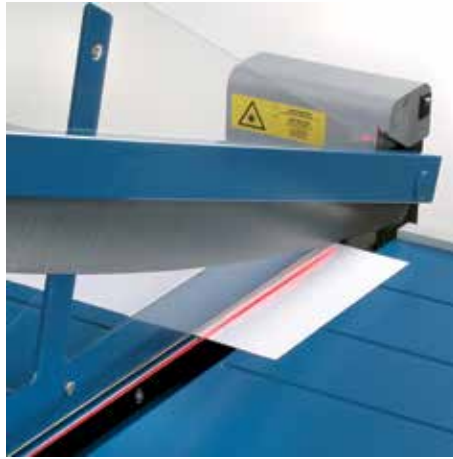
Präzise Laserlicht-Schnittandeutung sorgt für professionelle Schneideergebnisse - optional
